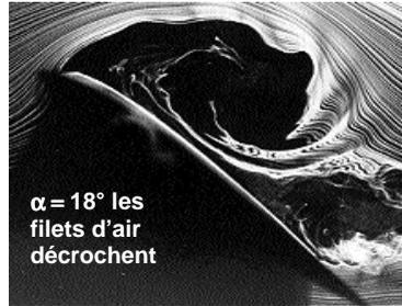
Avec l'augmentation de l'incidence, jusqu'à une certaine valeur (entre  $15^\circ$  et  $18^\circ$  sur les avions légers) la portance et la traînée augmente. (Voir leçon "Vitesse-incidence et vitesse-puissance") Puis les filets d'air se décrochent de l'extrados: C'est le décrochage.
