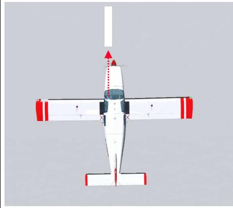
Il importe que l'avion et la roue avant soient parfaitement alignés sur la piste avant le décollage. Attention à l'erreur de parallaxe car le pilote est assis à gauche de l'axe longitudinal de l'avion.
