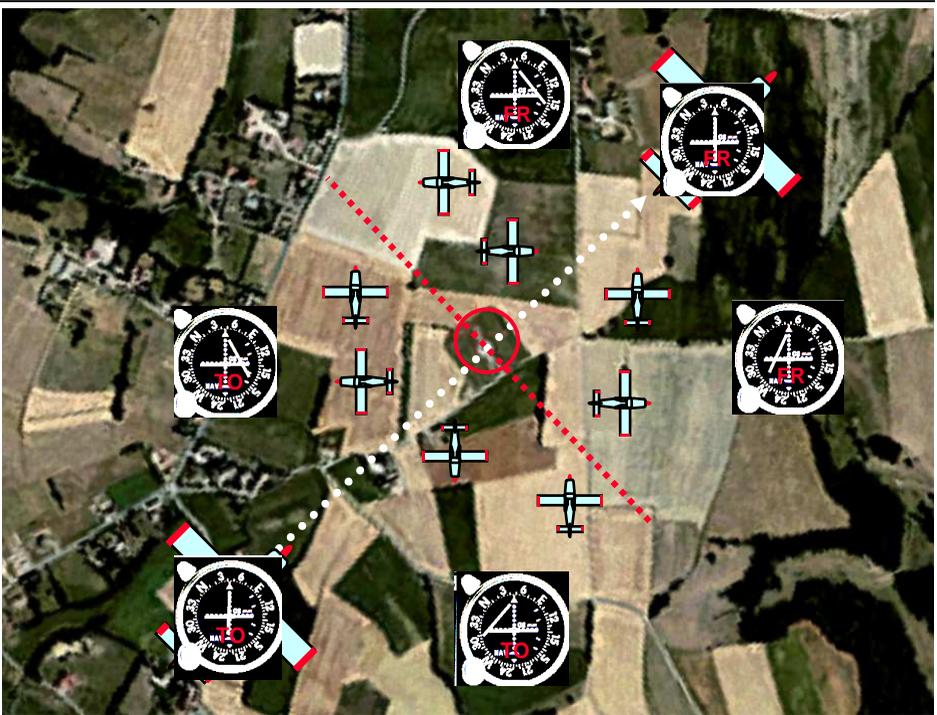
Sélectionner une route sur l'indicateur VOR détermine un axe radioélectrique. Mais choisir une route et l'afficher détermine également un autre axe imaginaire coupant perpendiculairement le premier à la verticale de la station.
