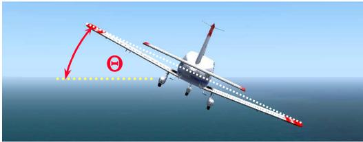
L'inclinaison de l'avion symbolisée par la lettre grecque phi ( $\Phi$ ), est l'angle compris entre l'horizontale et le plan moyen des ailes de l'avion.
