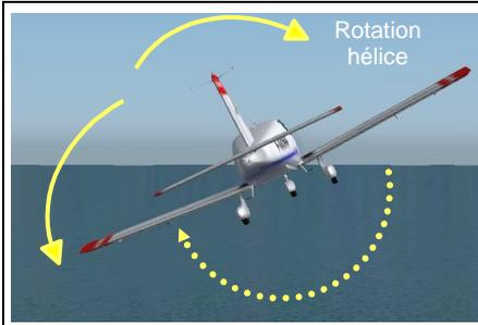
D ans le cas le plus fréquent d'un moteur qui tourne à droite comme sur l'illustration ci contre, le souffle hélicoidal de l'hélice provoque une diminution de l'incidence sur l'aile droite
