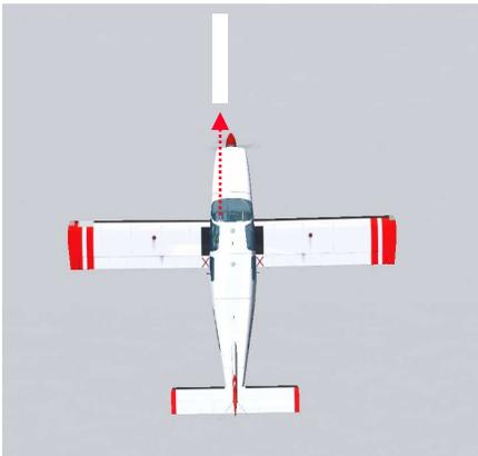
Un bon alignement est obtenu lorsque le pilote est assis sur l'axe réel ou imaginaire de roulement ceci afin d'éviter l'erreur de parallaxe.
